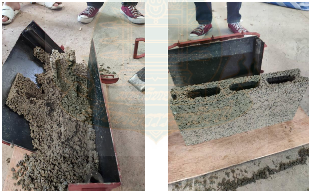
ภาพที่ 4.6 ผลการขึ้นรูปที่อัตราส่วนมอร์ตาร์ต่อมวลรวมที่ไม่สามารถขึ้นรูปได้และขึ้นรูปได้
