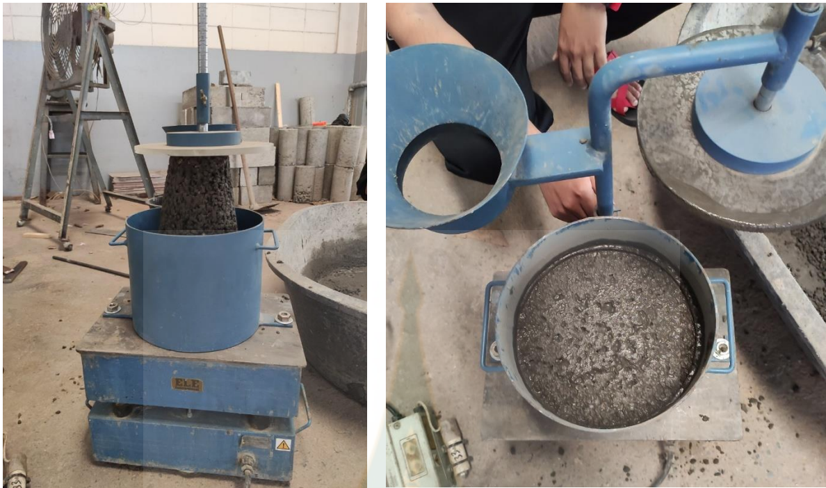
ภาพที่ 4.3 การทดสอบ Vebe Test ตามมาตรฐาน BS EN 12350-3
