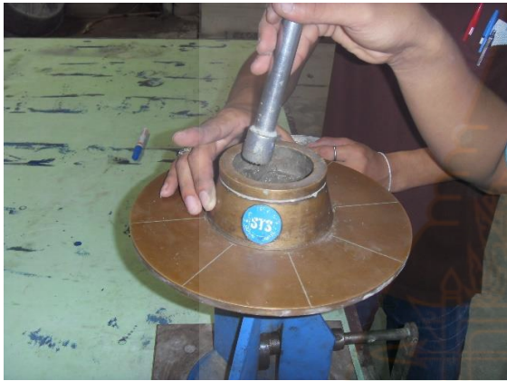
ภาพที่ 4.1 ทดสอบการไหลตามมาตรฐาน ASTM C230
