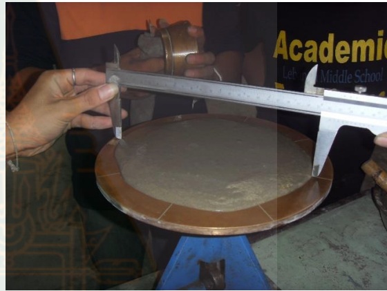
ภาพที่ 4.1 ทดสอบการไหลตามมาตรฐาน ASTM C230
