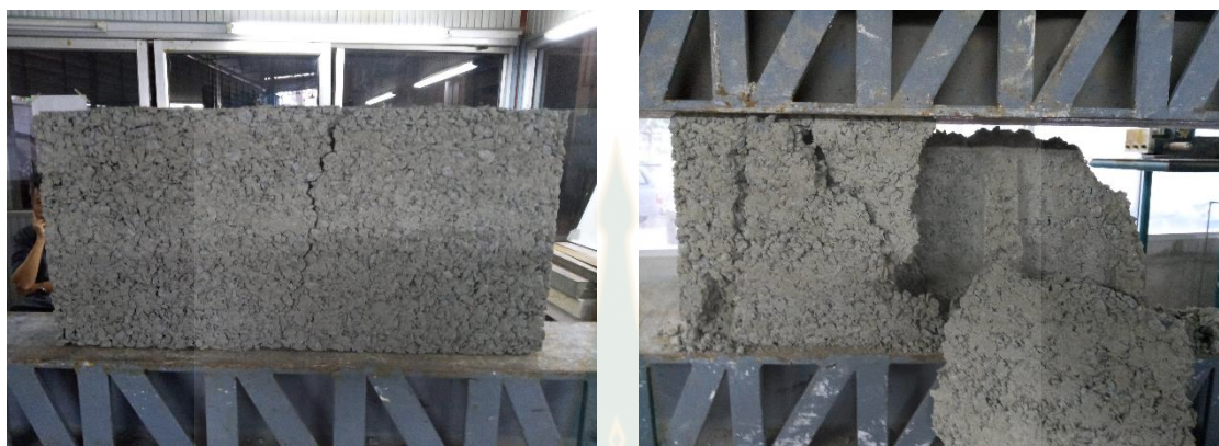
ภาพที่ 4.7 ผลการทดสอบกำลังรับแรงอัดที่ไม่สามารถทดสอบได้และทดสอบได้ที่อายุ 7 วัน
